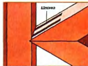
Рис. 10. Угловые соединения ромбовидного элемента жесткости удлиненной рамы усилены вклеенными шпонками из фанеры. Углы этого элемента врезают в раму на глубину 4 мм.
