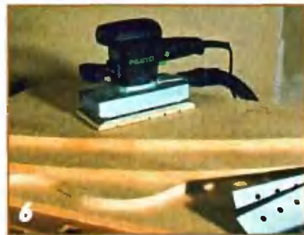
6 Кромки распила сначала обрабатывают шлифовальной шкуркой зернистостью 80, затем (вместе с пластинами заготовок) — зернистостью 180.
