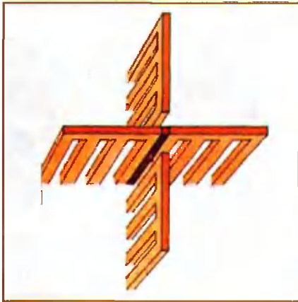
Рис. 3. Схема сборки каркаса приставного столика. Вид сверху.
