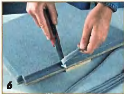
6 Укладывают на фанеру пеноматериал. Обрезают его по периметру фанеры, пользуясь резакром с новым лезвием.
