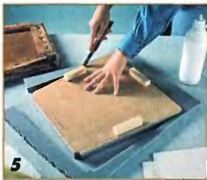
5 Раскраивают фанеру по размерам старого сиденья. Закрепляют фиксирующие бруски.
