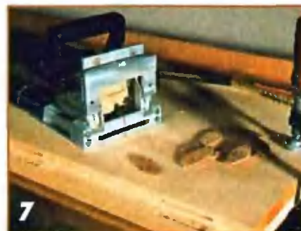
7 Детали из дерева соединяют друг с другом на плоских шкантах с клеем, выбирая пазы под них специальной фрезой с насадкой к угловой шлифовальной машинке или на круглых шкантах с клеем, высверливая отверстия под них электродрелью.
