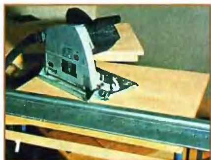
3 Заготовки выкраивают из клееного щита дисковой пилой.
