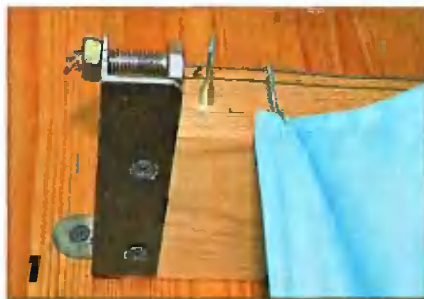
Болт со сквозным отверстием для натяжения струны я использовал от покупного карниза.
