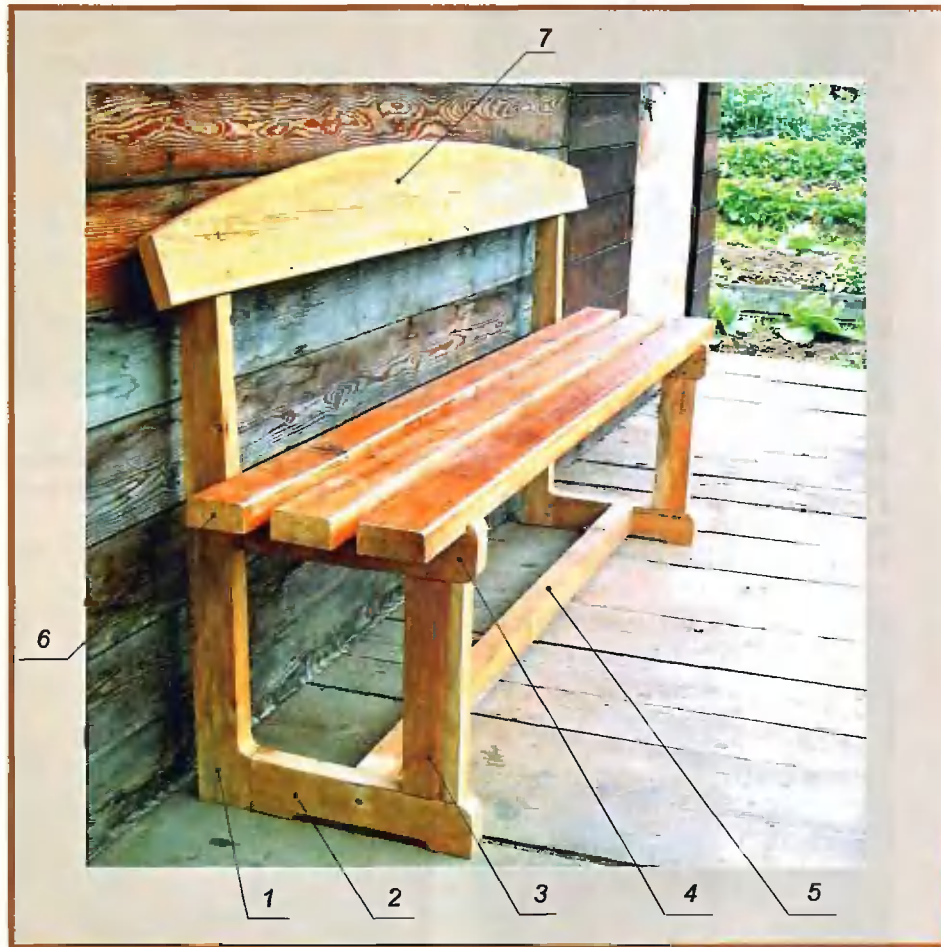
Скамейка садовая: 1 — стойка задняя (2 шт.); 2 — опора нижняя (2 шт.); 3 — стойка передняя (2 шт.); 4 — опора верхняя (2 шт.); 5 — проножка; 6 — брус сиденья (3 шт.); 7 — спинка.
