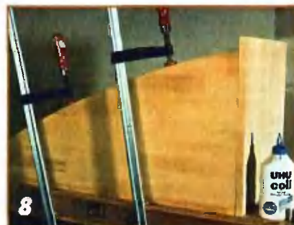
8 Соединенные на клею и шкантах детали временно, пока не затвердеет клей, зажимают струбцинами.
