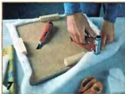
7 Второй слой состоит из нетканого материала, прикрепляемого к фанере с помощью степлера. Выступающие края обрезают до ширины 2 см.
